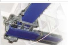
Línea de inspección con banda de PU negro y tacos para posicionamiento de producto. Estación de rechazo con accionamiento neumático
