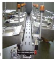
Estructura de soporte con regulación de inclinación y de altura.
